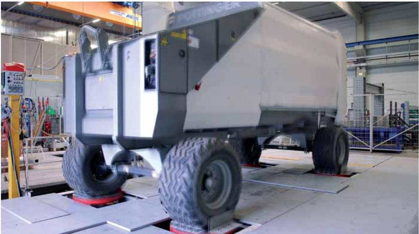
*Test con scosse ripetute servono a verificare la resistenza*
