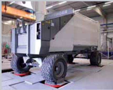
*Lunga durata, un requisito imprescindibile nelle condizioni di impiego più difficili. Test severissimi e una simulazione della durata di vita eseguiti presso il centro di collaudo Pöttinger garantiscono ai clienti lunga durata e funzionamento senza problemi del Press Container.*
