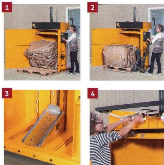
**1** Compacte los residuos y expulse la bala terminada. **2** Extraiga y almacene la bala hasta su recogida. **3** Un sistema de extracción eficaz y silencioso garantiza una manipulación sencilla de la bala. **4** Los rollos de correas se reemplazan fácilmente en la parte delantera de la máquina.
